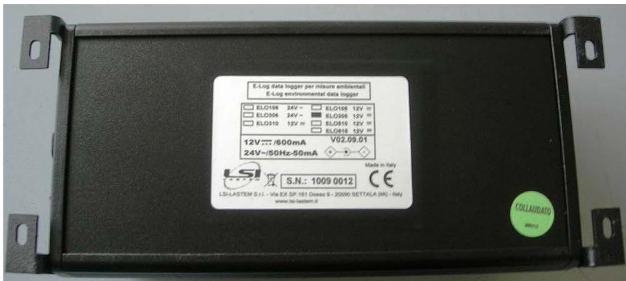
Figura 16: Targa identificativa della centralina Meteo Center
